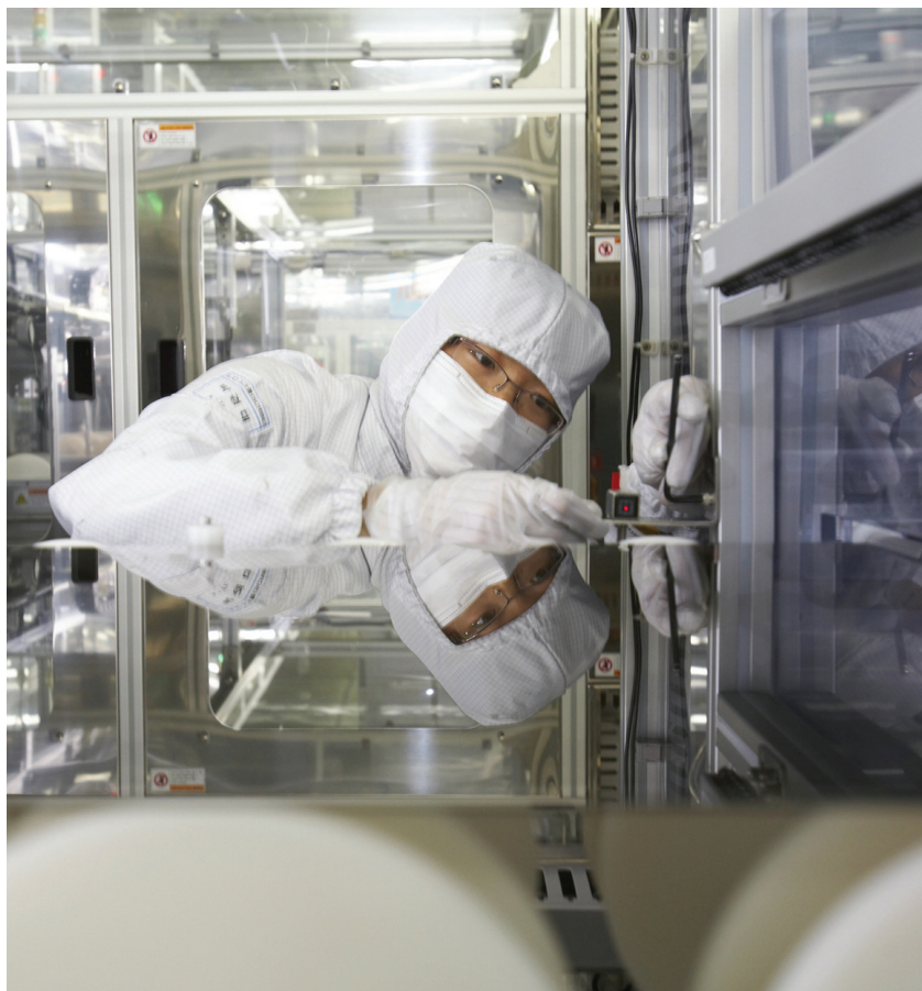
En las fábricas de LCD se comprueba que su capacidad para dejar pasar la luz funciona bien
