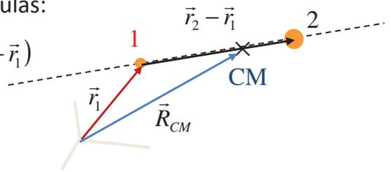
**§3.4** El momento angular total de un sistema de partículas es:  $\vec{L}_{(Q)} = \sum_i \vec{L}_{i(Q)} = \sum_i \vec{r}_{i(Q)} \times m_i \vec{v}_i$
