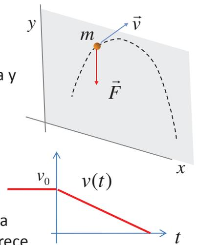
1) Calcular a que ángulo respecto del suelo hay que lanzar un objeto para que llegue lo más lejos posible, y calcular la velocidad del objeto justo antes que toque el suelo; 2) Hallar la dinámica de una masa sujeta a fricción dinámica ( $\mu_D = 0.1$ ) que sale del origen con  $v_0 = 3 \text{ ms}^{-1}$
