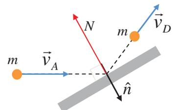
Importante: Para una colisión entre un cuerpo y una pared fija:  $v_{D}'' = v_{A}''$
